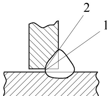
1 – по металлу шва; 2 – по металлу границы сплавления
