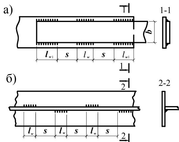
*a* – в нахлесточном соединении; *б* – в тавровом соединении
