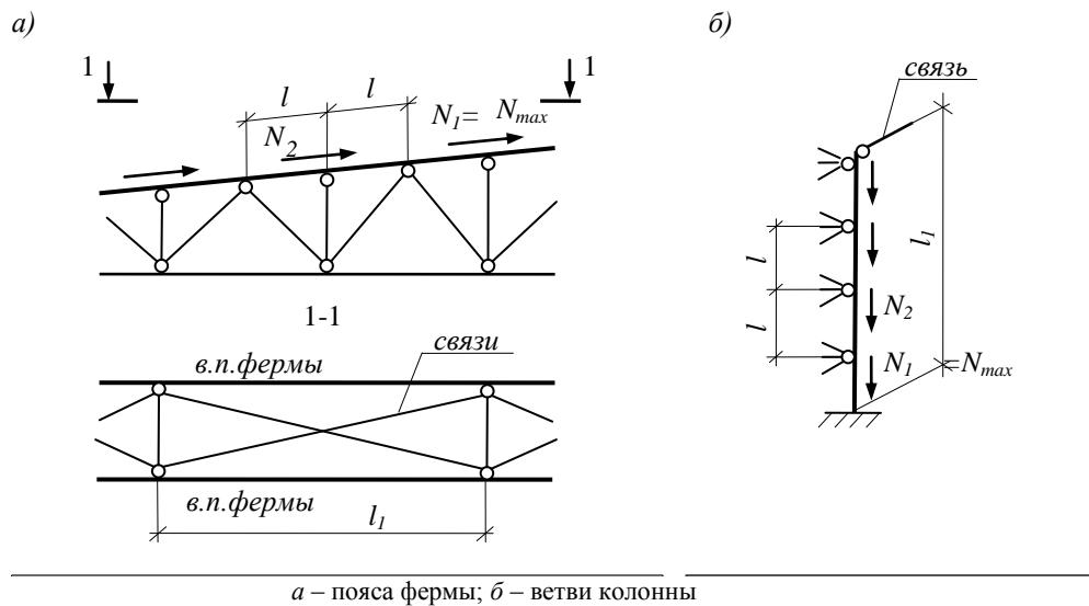
Рисунок 14 – Схемы для определения расчетной длины элементов
