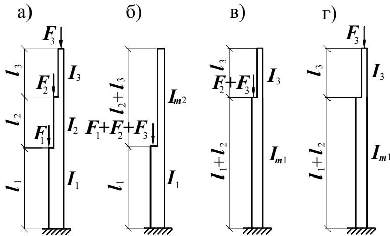
**Рисунок И.1 — Схема двухступенчатой колонны (а) и условные схемы загружений при приложении сил  $F_1$ ,  $F_2$  и  $F_3$  соответственно к нижнему (б), среднему (в), верхнему (г) участкам**
