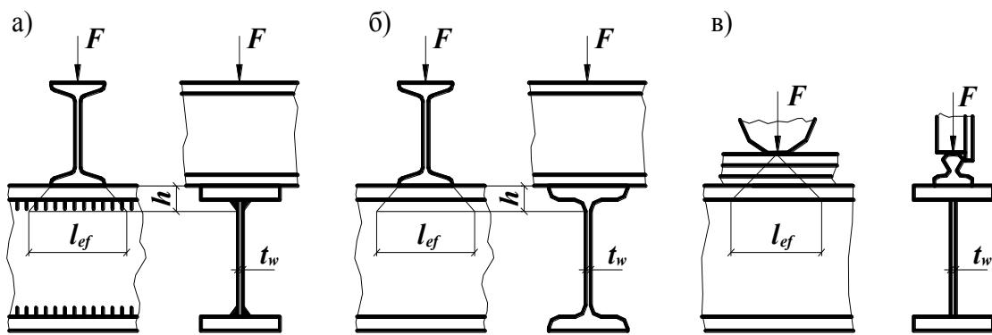
*a – сварная; б – прокатная; в – сварная или прокатная при нагрузке от колеса крана*
