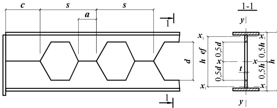
Рисунок M.2 — Схема участка балки с перфорированной стенкой
