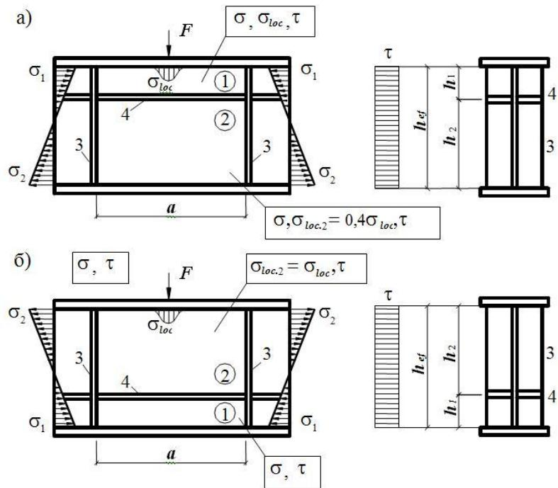
*a* – балка со сжатым верхним поясом; *б* – балка с растянутым верхним поясом
