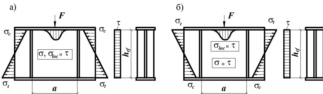
*а* – приложении сосредоточенной нагрузки к сжатому поясу; *б* – то же, к растянутому поясу
