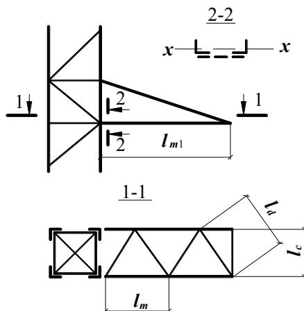
Рисунок 22 – Схема траверсы с треугольной решеткой
